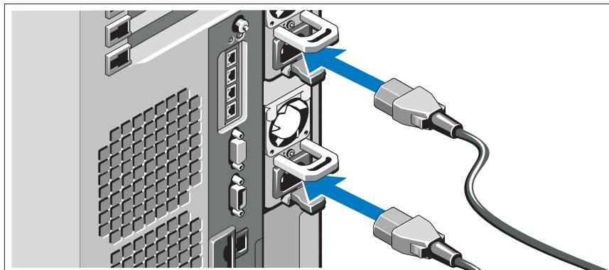
システムの電源ケーブルをシステムに接続し、モニターを使用する場合は、モニターの電源ケーブルをモニターに接続します。
