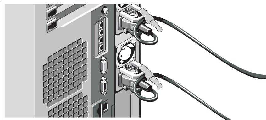
如图所示，将系统电源电缆弯曲成一个环路，并使用所提供的腕带固定该电缆。
