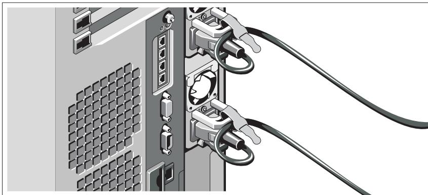
그림과 같이 시스템 전원 케이블을 루프 모양으로 구부려서 제공된 끈으로 케이블을 고정합니다.
